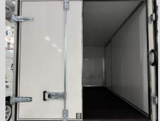
Применение: настил пола, противоударная защита передней стенки, противоударная защита бортов
